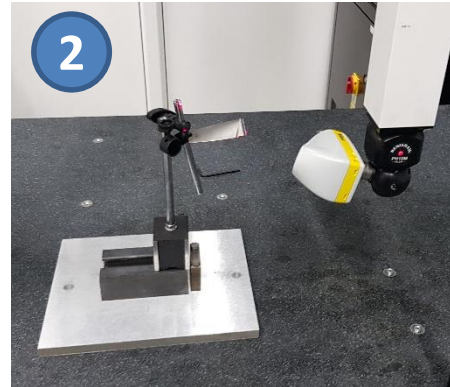
2D триангуляционный сканер и КИМ Altera
