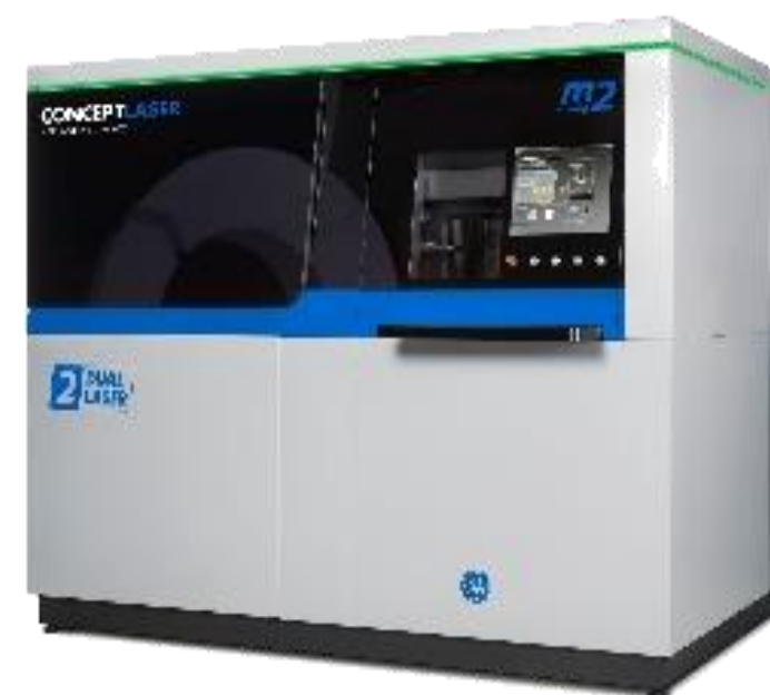
CONCEPT LASER M2 МАТЕРИАЛЫ: 316L РАБОЧАЯ ЗОНА: 225X225X280 мм
