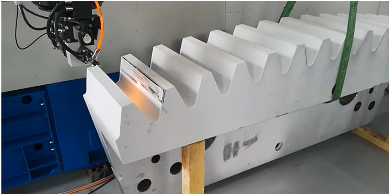
Закалка эвольвент ковша экскаватора
