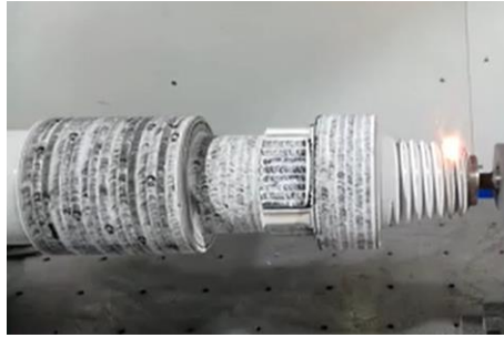
Буровые штанги (резьба + поверхность износа). Проведены опытные обработки штанг, оборудование поставлено на испытания
