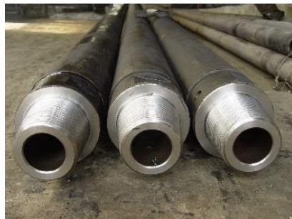
Буровые штанги (резьба + поверхность износа). Проведены опытные обработки штанг, оборудование поставлено на испытания
