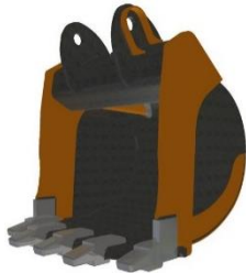
Футеровка ковша экскаватора, потенциальная Проведена опытная наплавка, оборудование на испытаниях
