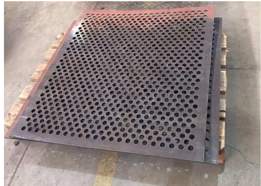
Закалка сит для грохотов – замена Hardox на более дешевые марки
