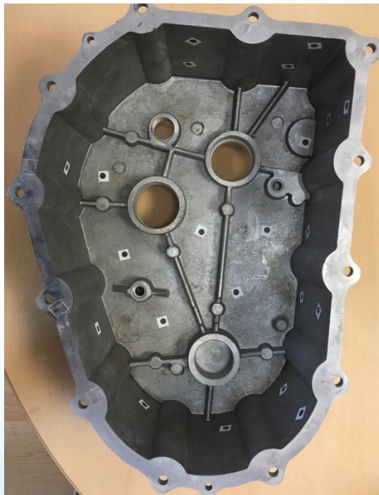
Крышка вариатора – алюминиевая отливка с мех. обработкой
