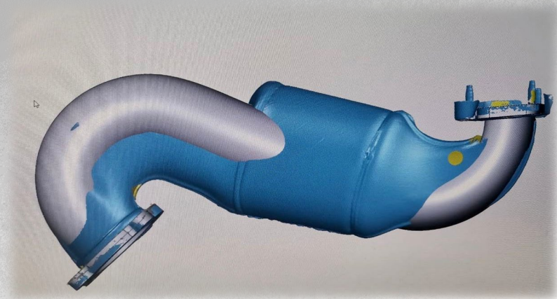
Скан оригинального даунпайпа И спроектированная модель без катализатора
